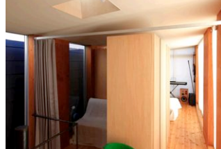
耐力壁がないことから2本の可動クローゼットによって間仕切り、時々に応じて間取りを変更できる。当初は並列に配置してウォークインクローゼットのようなレイアウトで寝室側を広く使う想定から、現在は納戸も兼ねた小部屋にソファベットを置き、ちょっとしたゲストスペースとして使っている。
